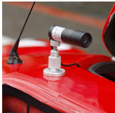
De Saker GT is voorzien van een achteruitkijkcamera, zodat de coureur op een kleurschermje achter het stuur kan zien wat er achter hem gebeurt.
