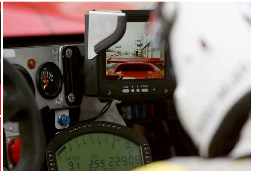
De Saker GT is voorzien van een achteruitkijkcamera, zodat de coureur op een kleurschermje achter het stuur kan zien wat er achter hem gebeurt.
